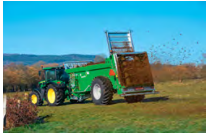
Tieflader mit grosser Bereifung und zwei Streuwalzen mit grossem Durchmesser. Bild: Joskin
